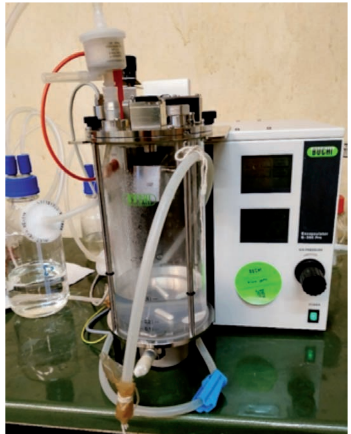
Рис. 1. Лабораторная полуавтоматическая установка B-395 Pro Encapsulator швейцарской фирмы Büchi. Внешний вид в рабочем состоянии.
